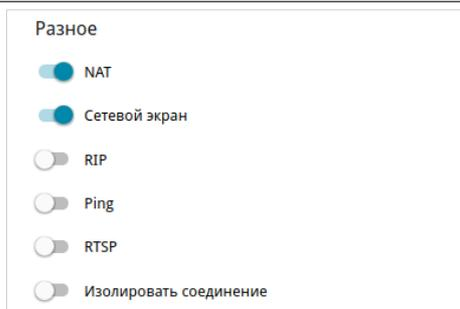
Рисунок 59. Страница добавления соединения типа **PPPoE**. Раздел **Разное**.
