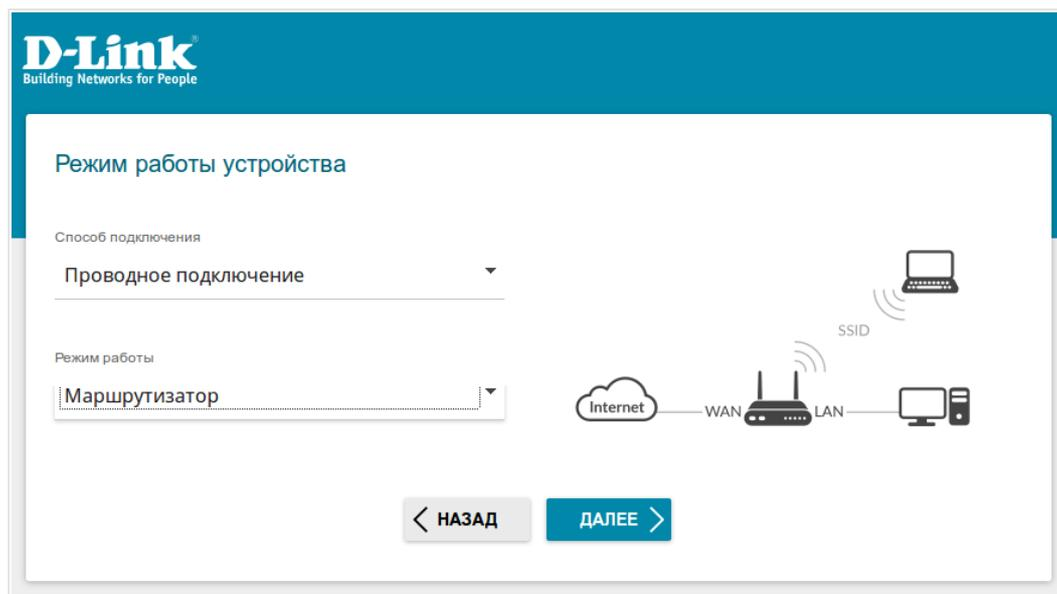
Рисунок 22. Выбор режима работы устройства. Проводное подключение.
