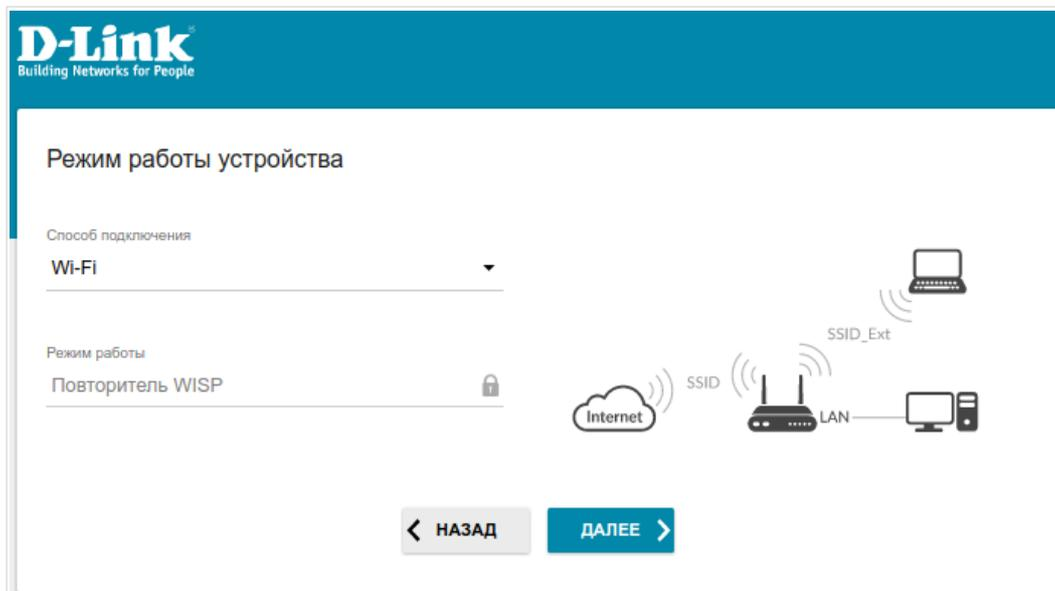
Рисунок 23. Выбор режима работы устройства. **Wi-Fi**.
