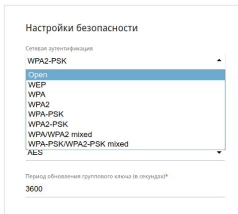
Рисунок 76. Типы аутентификации, поддерживаемые маршрутизатором.
