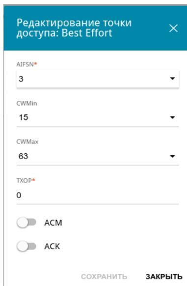
Рисунок 83. Окно для изменения параметров функции WMM.
